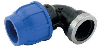
ZEL52 Vinkelkoppling inv gänga 16x1/2"-110x4" Mellan 1/2"-1" utan förstärkningsring Från 1 1/4" med förstärkningsring
