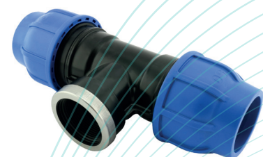
ZTE42 T-koppling inv gänga 16x1/2"-110x4" Mellan 1/2"-1" utan förstärkningsring Från 1 1/4" med förstärkningsring
